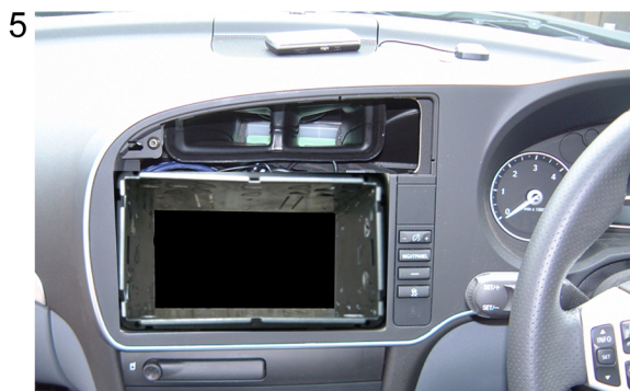
Fit the double din metal bracket.
